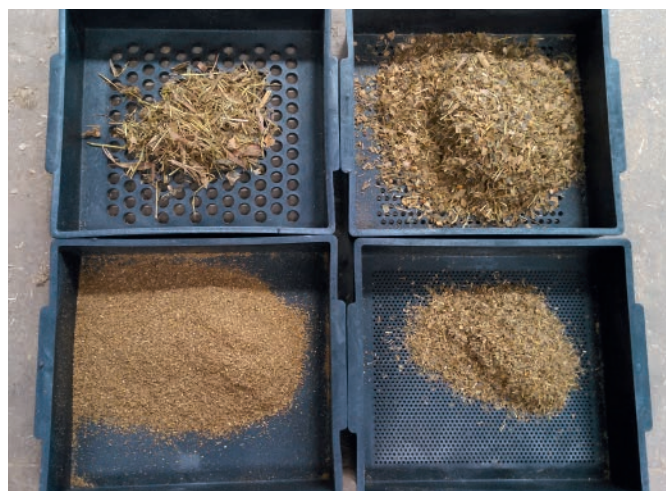
Jól összeállított TMR. A szitákon maradó anyagmennyiség megfelel az ajánlott értékeknek (fölső: 6% [2-8%], középső: 45,5% [30-50%], alsó: 12,5% [10-20%], tálca: 36% [30-40%]). Ebben az esetben takarmány válogatás nem volt megfigyelhető.
